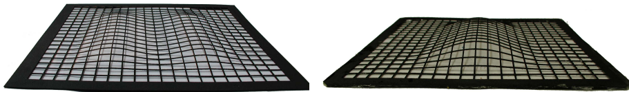
Fig. 4.6. Polyacrilamid grids (grid 1: \lambda_0=80\text{mm} - \eta_0 = 3\text{mm} , grid 2: \lambda_0=120\text{mm} - \eta_0 = 6\text{mm} ).
